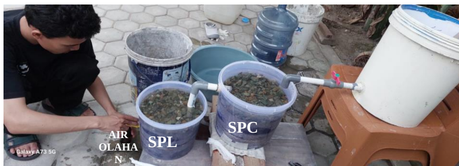
Gambar 1. Desain TLTG gravity fed system Skala Rumah Tangga
